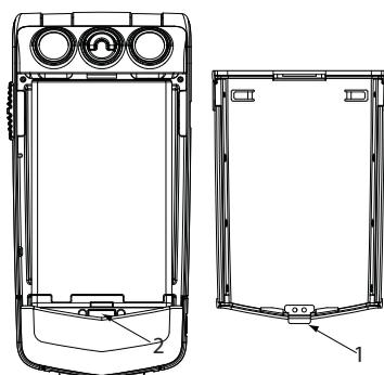
Чтобы установить на место крышку аккумуляторного отсека, аккуратно вставьте внутренний выступ (1) на крышке аккумуляторного отсека в выемку ниже аккумулятора (2).
