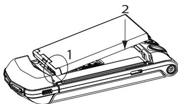
Вставляйте аккумулятор под таким углом (1), чтобы контакты на аккумуляторе совместились с контактами в аккумуляторном отсеке.
