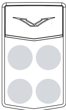
Внешний дисплей является сенсорным в четырех областях, обозначенных выше, и обеспечивает быстрый доступ к некоторым полезным функциям.
