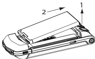
При помощи ногтя приподнимите аккумулятор из аккумуляторного отсека (1).
