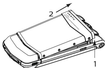
Слегка приподнимите крышку аккумуляторного отсека (1) и аккуратно сдвиньте ее вверх (2).
