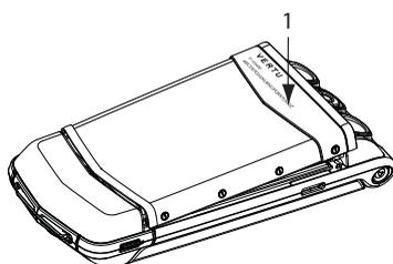
Опустите крышку аккумуляторного отсека на место (1) до щелчка. Крышка должна закрываться плотно при очень легком нажиме.
