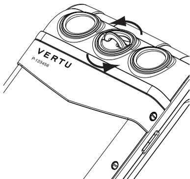
Поверните телефон Vertu задней панелью к себе, приподнимите ногтем верхнюю половину D-образного кольца для открытия крышки аккумуляторного отсека.
